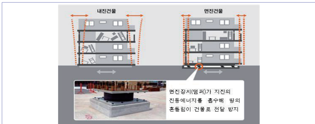
기초에 댐퍼 설치
