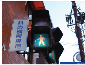
음향표시신호기 횡단지점에서 들을 수 있게 소리로 파란신호를 알려 안전하게 횡단할 수 있게 한다.
